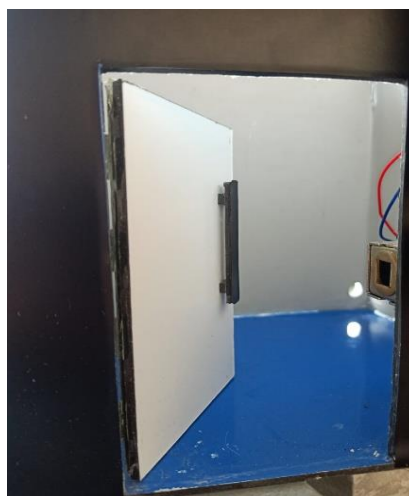
Gambar 4. Tampilan selenoid door lock terbuka
